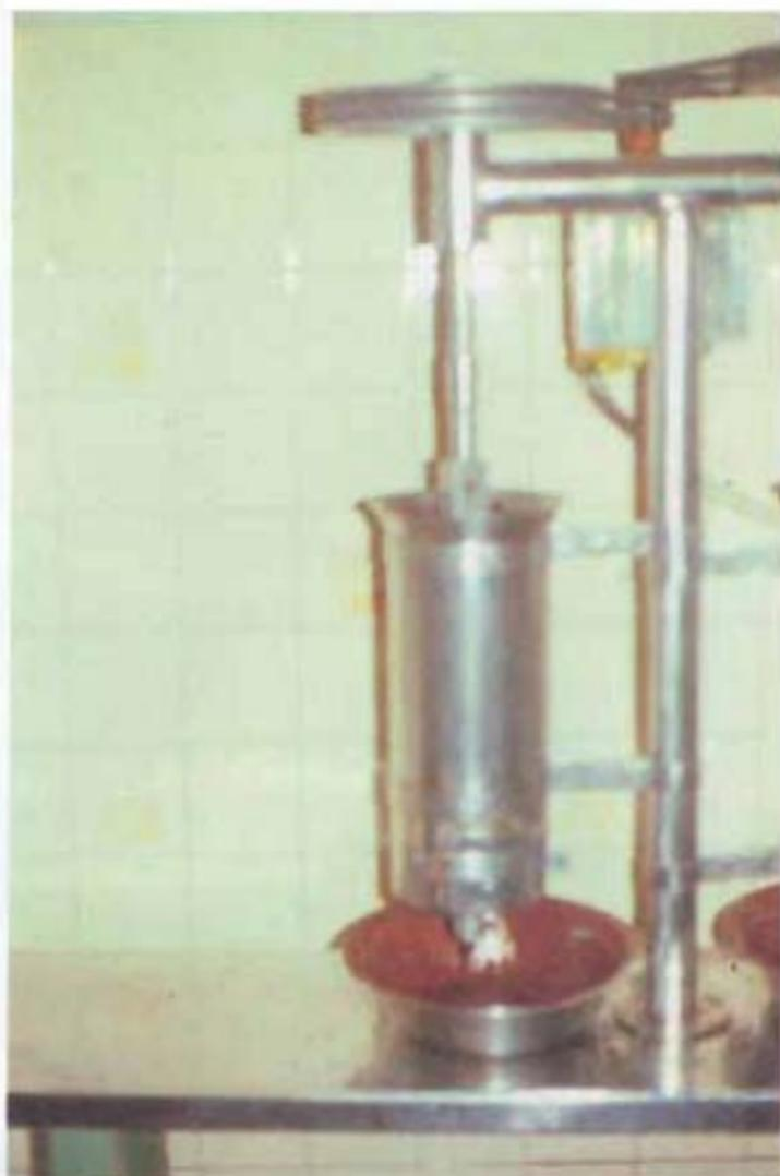
**Fig. 6. Máquina para preparar o suco de açai. Na bacia, o suco.**
