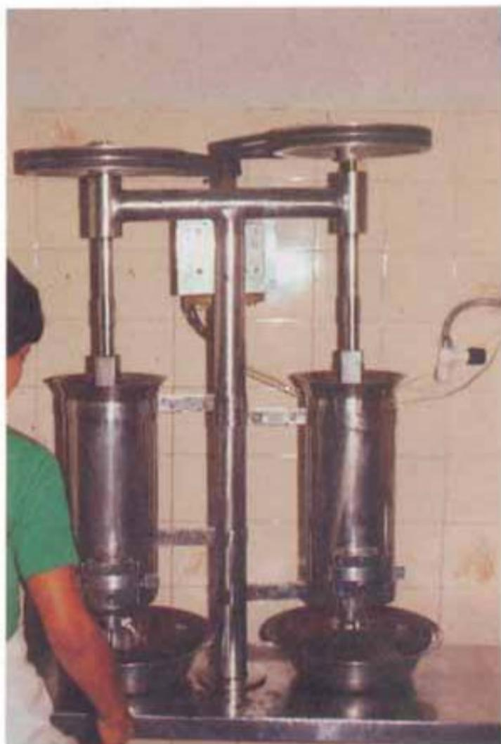
**Fig. 8. Duas máquinas de fazer suco de açai acionadas por um só motor. Na bacia, o suco.**
